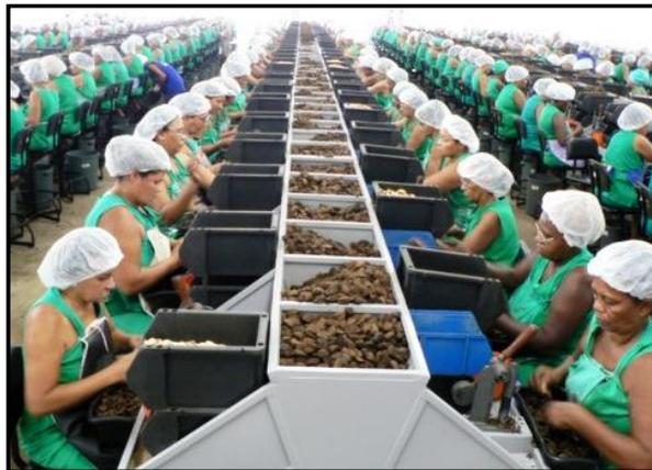
Figura 10. Descascamento das castanhas utilizando descascadores manuais.
