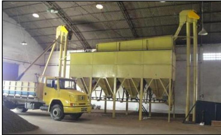
Figura 9. Classificador cilíndrico rotativo para castanha com casca.
