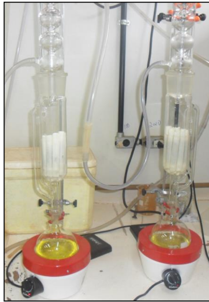
Figura 10. Extração do óleo de canola utilizando o sistema soxhlet e o solvente extrator éter de petróleo
