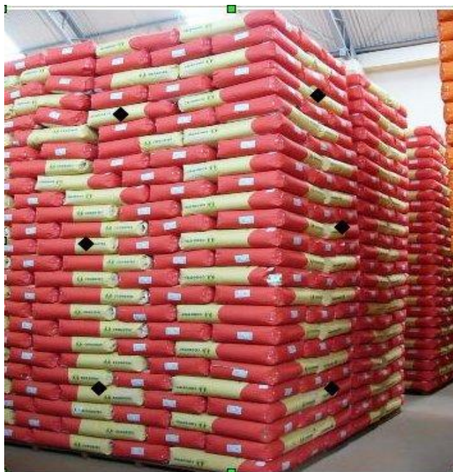
Figura 2: Bloco no interior do armazém. Os pontos em destaque são locais onde o termômetro foi inserido.
