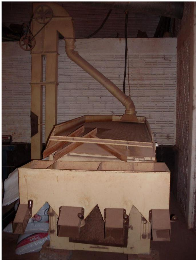
Foto 18. Equipamento de pré-limpeza da UBS de Capanema.
