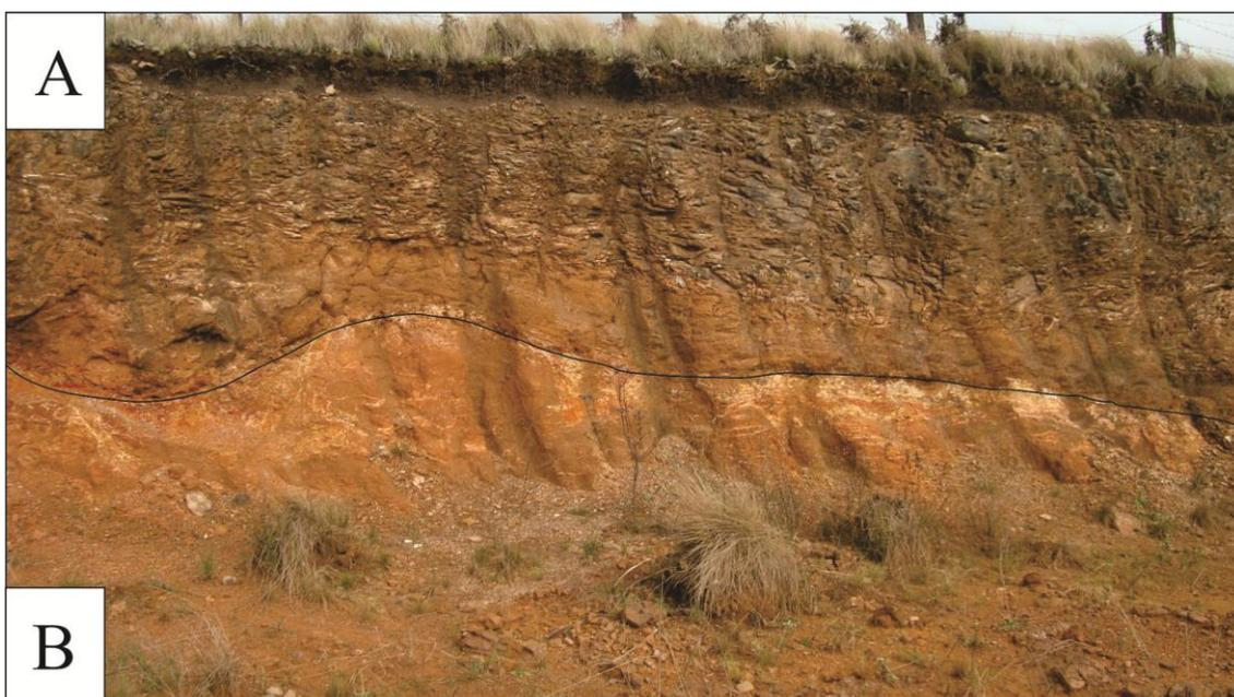
**Figura 2.** Afloramento de riolito sã (letra A) sobre derrame completamente intemperizado (letra B) - Palmas - PR. Fonte: Jacson Gosman Gomes de Lima, 2010.
