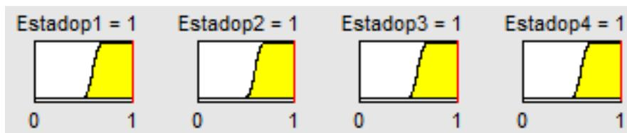
Figura 6.5: Entrada do controle nebuloso quando não tem falta nos propulsores.
