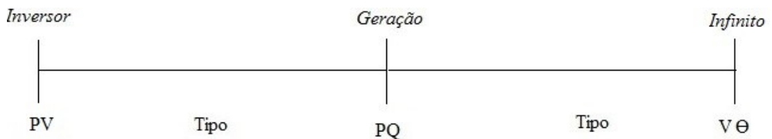
Figura 4.11: Diagrama unifilar representando a rede elétrica de três nós.
