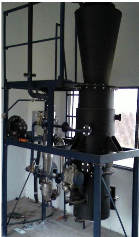
**Figura 7-** Unidade de gaseificação instalada no laboratório de Bioenergia
