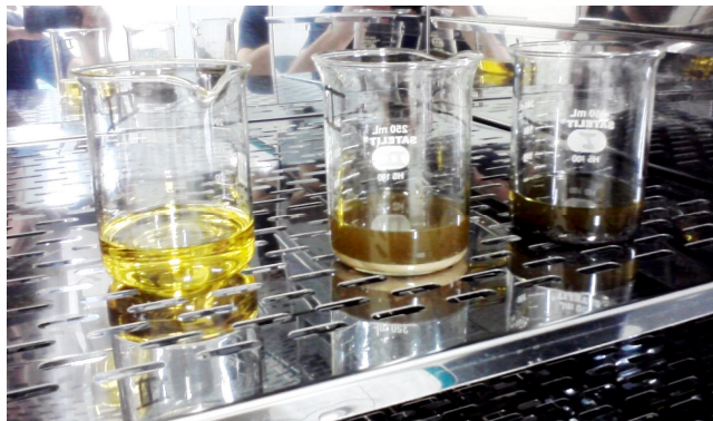
Figura 3.7 – Amostras, em beckers, submetidas ao stress térmico em estufa.
