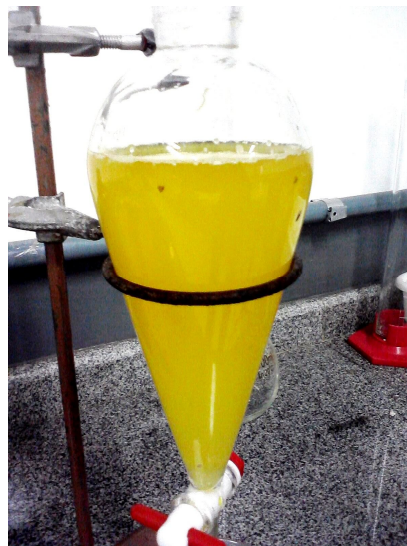
Figura 3.5 – Etapa de lavagem do biodiesel.
