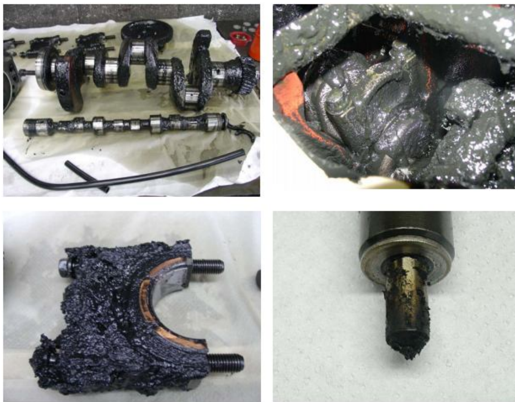
Figura 2.1 - Acúmulo de borras no interior do motor e depósito de carvão no bico injetor, observadas com o uso de óleo bruto de girassol (Fonte: Centro APTA de Engenharia e Automação).
