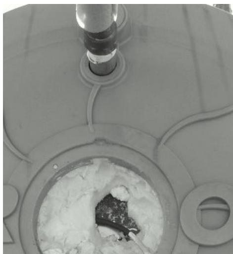
FIGURA 11 – Sensor 4, instalado na parede interna do reservatório térmico.
