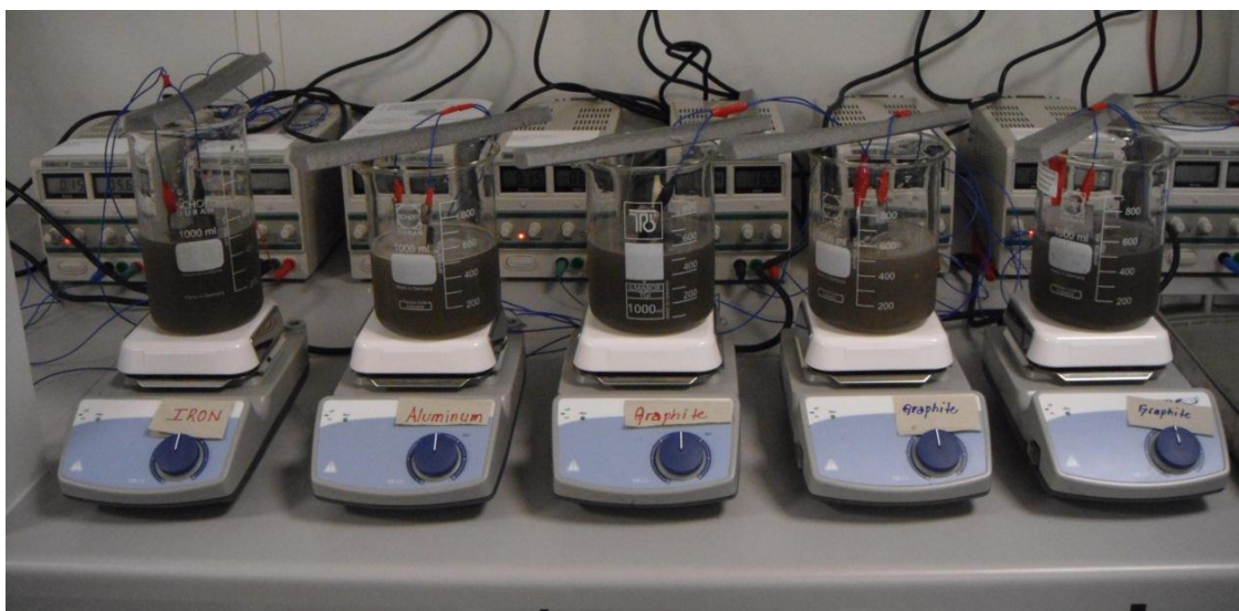
Figura 9. Ensaios de Eletrocoagulação e Eletro-oxidação(500mL esgoto bruto).
