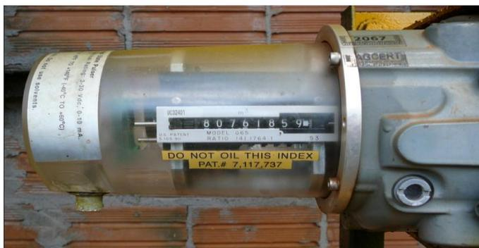
Figura 13 - Medidor Roots Meter Dresser (DRESSER, 2011)
