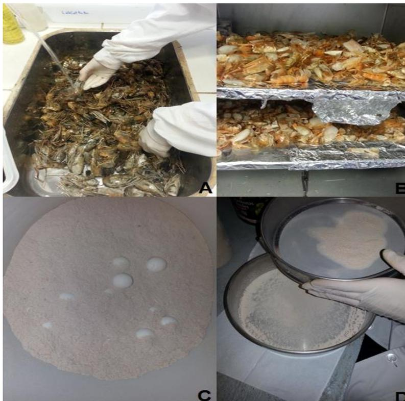
Figura 19. Processamento da carapaça. A- Separação e limpeza da carapaça; B- Secagem em estufa; C- Moagem em moinho de jarros; D- Peneiramento até passagem em malha de 63  $\mu\text{m}$  de abertura.
