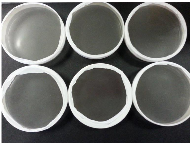
Figura 22. Estiramento das membranas para secagem à temperatura ambiente.
