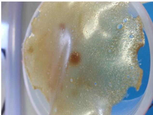
Figura 27. Membrana MQA ressecada e com aspecto queimado.
