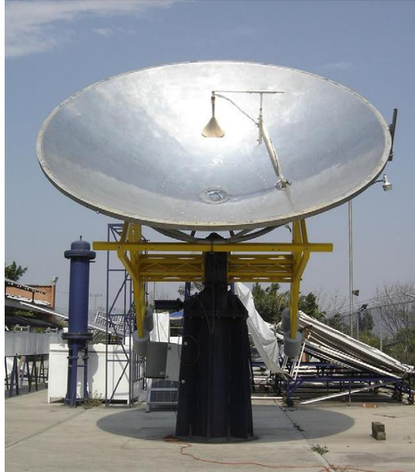
Figura 15: Concentrador solar de disco parabólico com receptor cônico.
