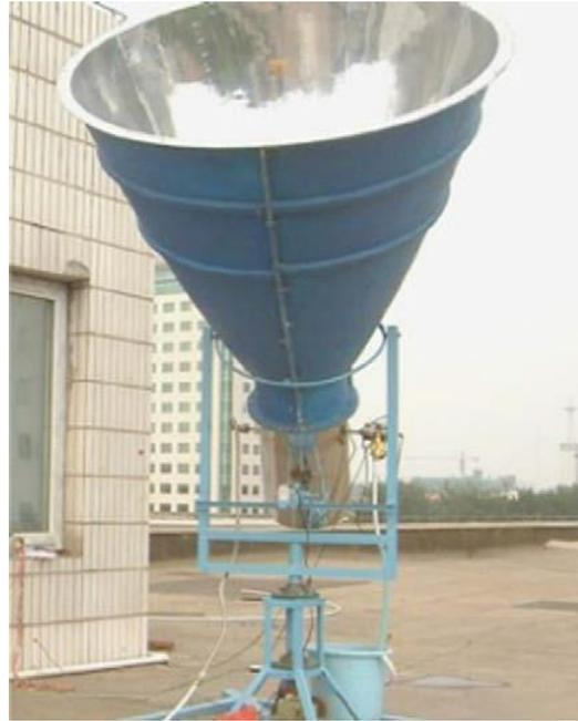
Figura 22: Funil concentrador solar congregado a um forno solar.
