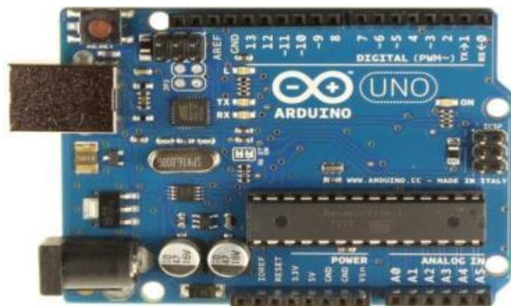
Figura 38: Placa Arduino® utilizada como datalogger.
