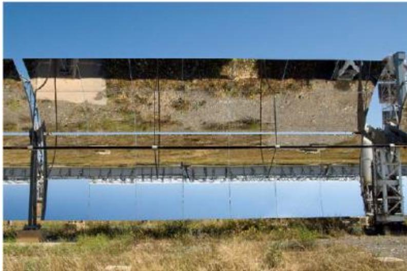
Figura 12: Exemplo de concentrador de calha parabólica de uso em usinas solares.
