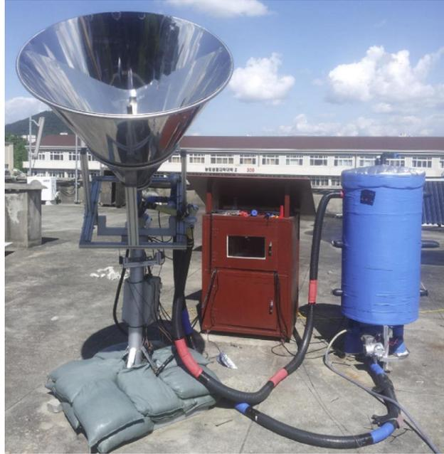
Figura 21: Coletor solar com concentrador cônico.
