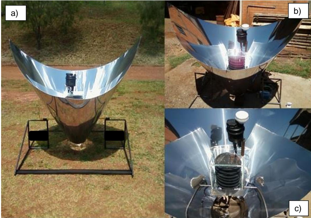
Figura 25: a) Coletor solar de funil; b) Concentrador com vista para o absorvedor; c) Detalhe do absorvedor.
