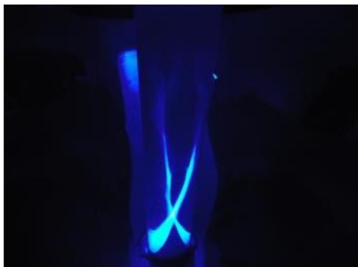
Figura 63: Foco formado pela luz com ângulo de incidência igual a  $30^\circ$ .
