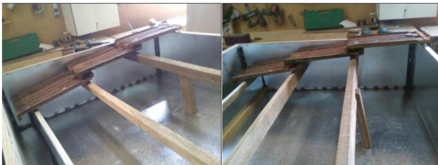
Figura 7: Montagem protótipo para telhado convencional.
