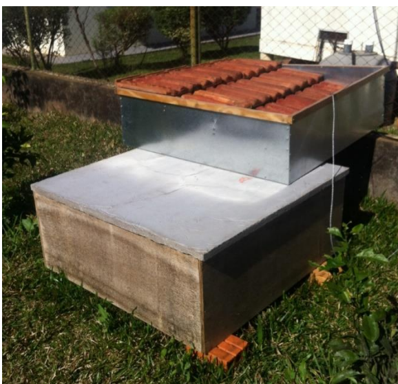
Figura 6: Colocação da laje no protótipo de telha convencional.
