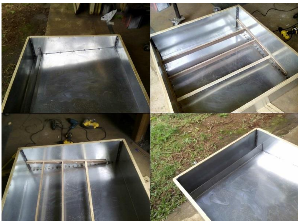
Figura 11: montagem protótipo para telhado verde.
