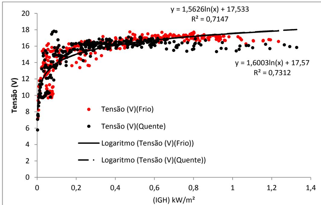
Figura 32. Interação (2) entre tensão e irradiação solar global incidente no plano.
