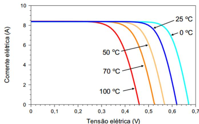
Figura 18. Influência da variação da temperatura da célula fotovoltaica solar na curva característica I-V de uma célula fotovoltaica de silício cristalino a uma irradiação solar constante de 1000 W/m<sup>2</sup>.
