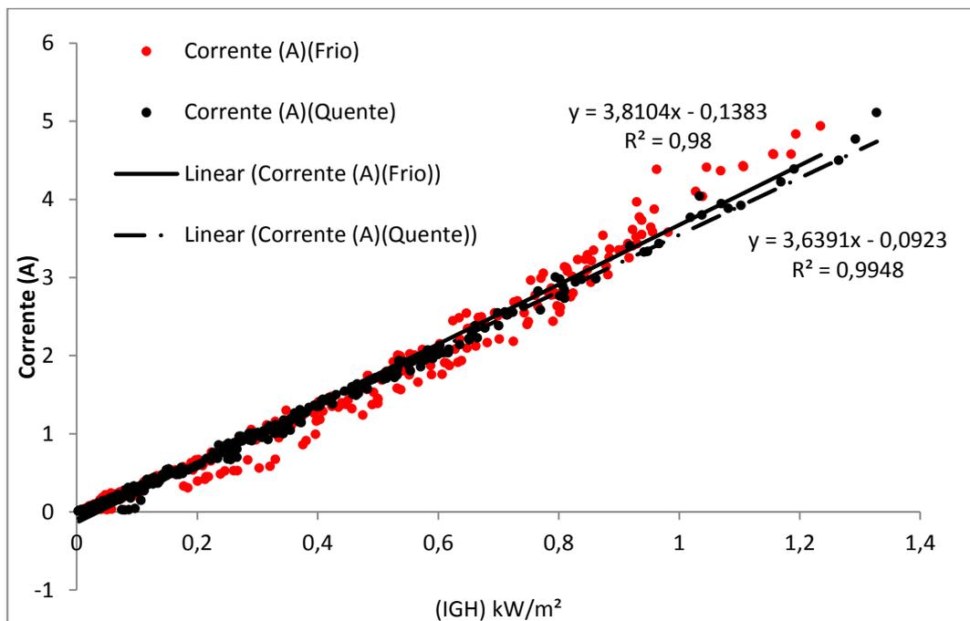
Figura 31. Interação (1) entre corrente e irradiação solar global incidente no plano.
