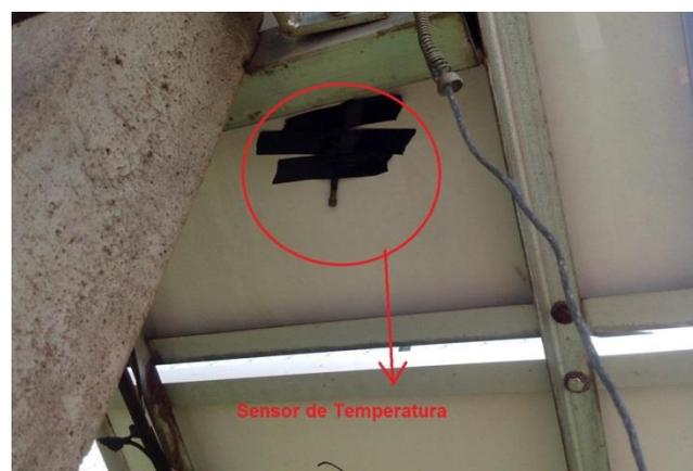
Figura 25. Termopar tipo J instalado em um dos painéis do conjunto.
