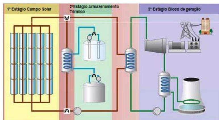
Figura 5. Diagrama esquemático de uma usina com acumulação térmica.
