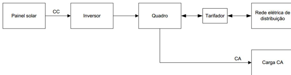
Figura 13. Diagrama de blocos de um sistema de geração de energia elétrica distribuída.
