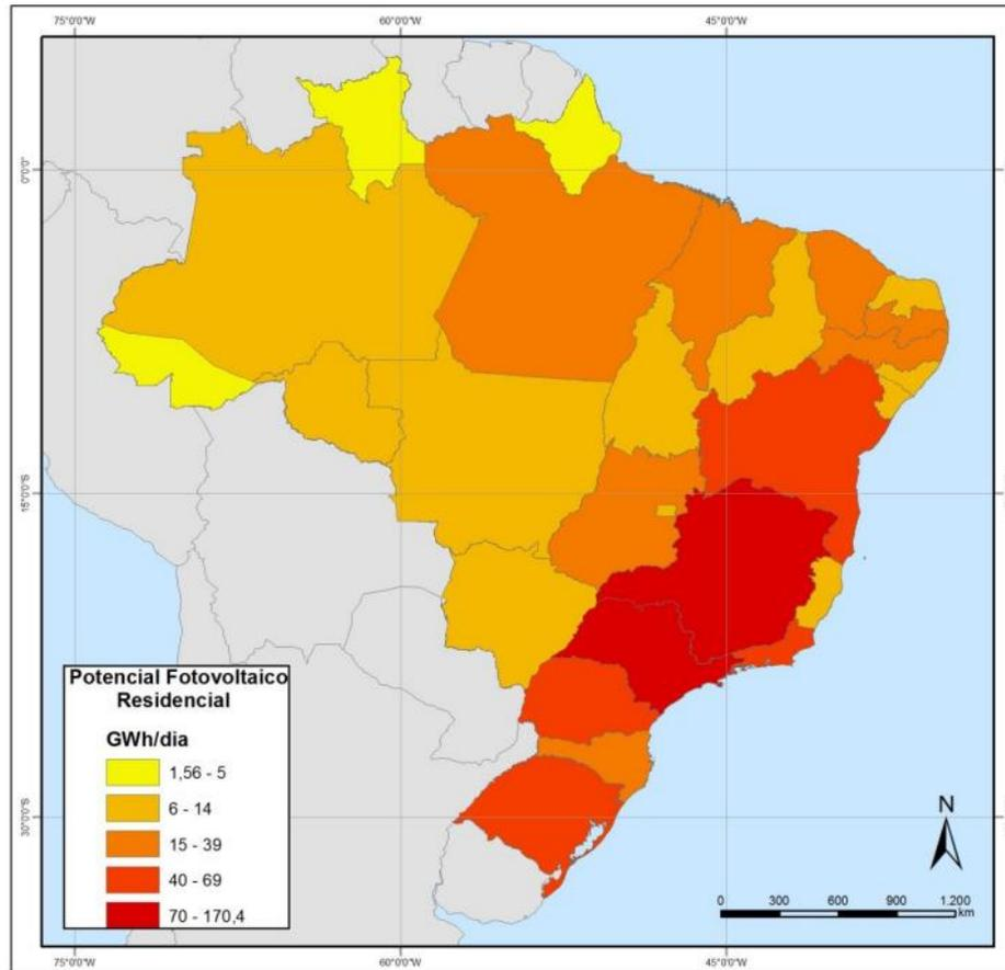
Figura 14. Potencial Técnico de geração fotovoltaica em telhados residenciais por unidade da federação (GWh/dia).
