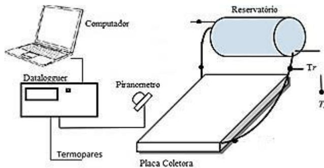
Figura 17. Esquema da coleta dos dados montado no experimento.
