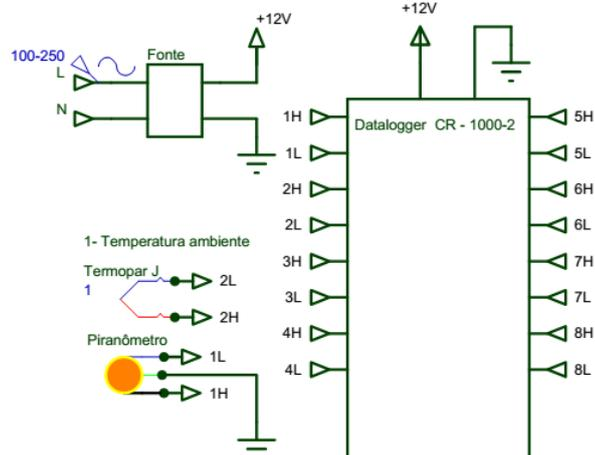
Figura 28. Diagrama de conexões físicas ao Datalogger CR -1000-2
