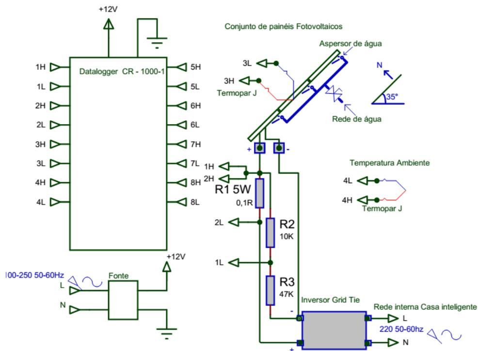
Figura 27. Diagrama de conexões físicas ao datalogger CR -1000-1
