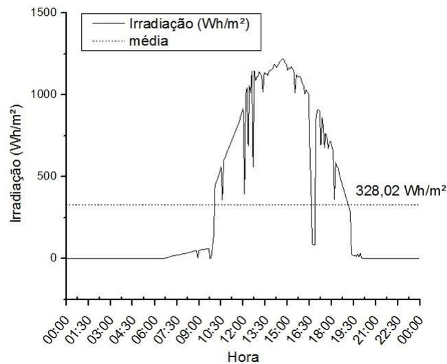
Figura 20. Irradiação solar global no plano inclinado (IGH) ao longo do dia 20 de Dezembro de 2014.
