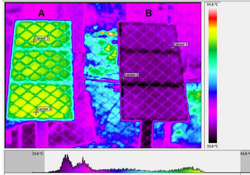
Figura 30. Imagem térmica dos painéis após o resfriamento.
