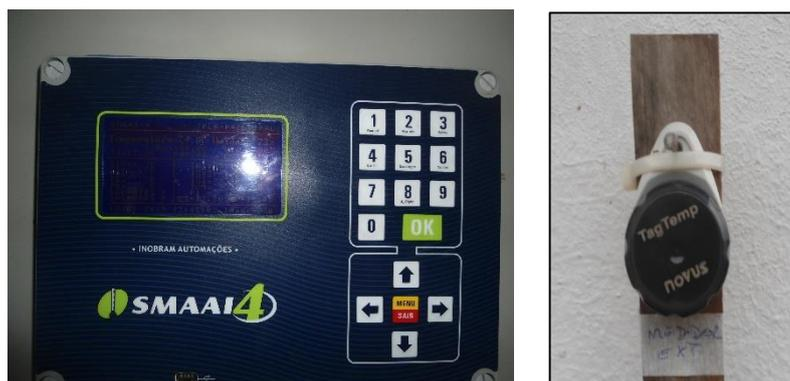
Figura 12. Registrador de temperatura interna no aviário 2 e medidor de temperatura externa.
