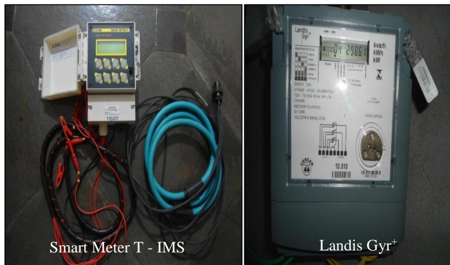
Figura 11. Registrador Smart Meter IMS e medidor Landis Gyr<sup>+</sup>.
