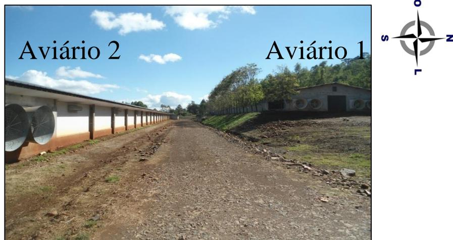
Figura 4. Aviário 1 - *dark house* sem isolamento térmico e iluminação com lâmpadas incandescente. Aviário 2 - *dark house* com isolamento térmico e lâmpadas de *LED*.
