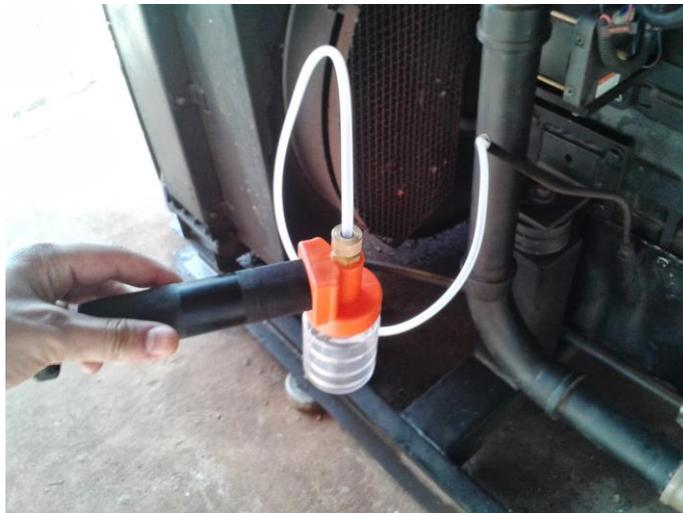
**Figura 11.** Bomba de coleta de lubrificante a vácuo, inserida na haste da vareta de lubrificante para a obtenção das amostras.
