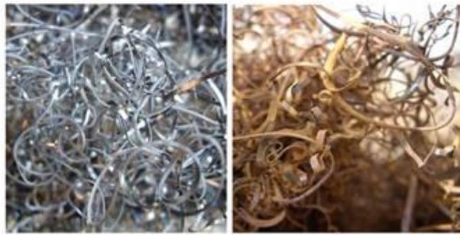
**Figura 1.** Limalha de ferro antes e depois da oxidação pelo gás sulfídrico.
