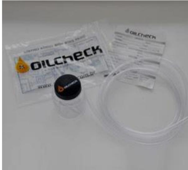
**Figura 12.** Kit de coleta de lubrificante, fornecido pelo laboratório terceirizado.
