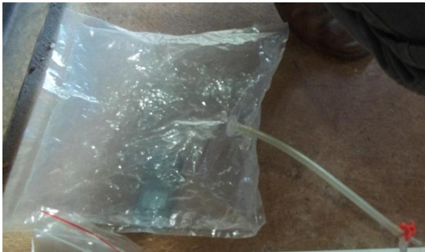
**Figura 13.** Bolsa amostradora utilizada para a coleta de biogás.
