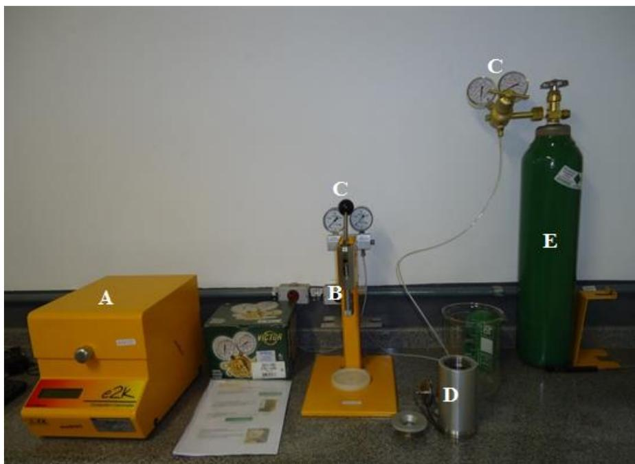
**Figura 13 - Equipamento para determinação do poder calorífico superior. (A) Calorímetro; (B) Válvula de enchimento; (C) Manômetros; (D) Vaso calorimétrico; (E) Cilindro de oxigênio. (Laboratório da UNIOESTE).**
