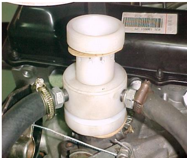
Figura 6 - Misturador tipo Venturi Fonte: Souza 2004.
