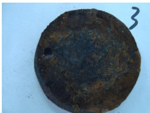
Figura 32: Detalhe do mesmo corpo de prova da figura 31, ao ser retirado, antes da limpeza química.
