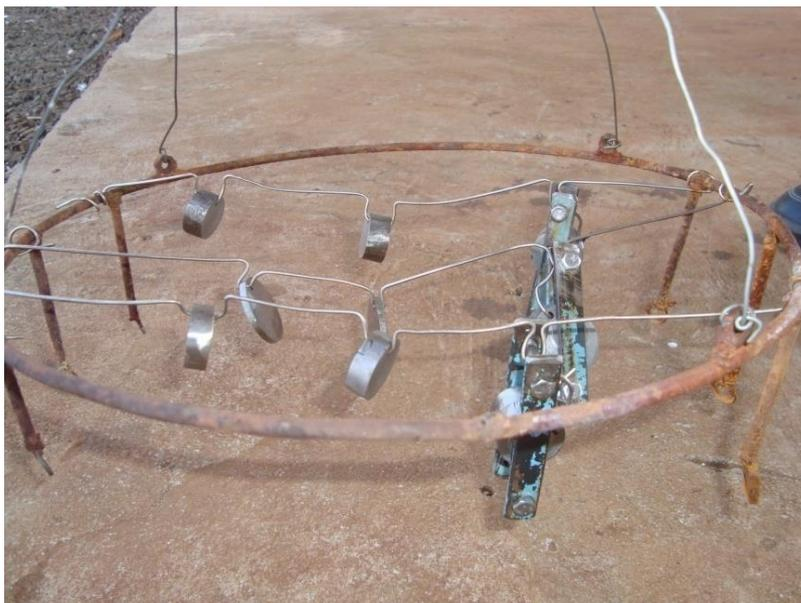
Figura 24: Fotografia da estrutura de sustentação dos corpos de prova na base da chaminé.
