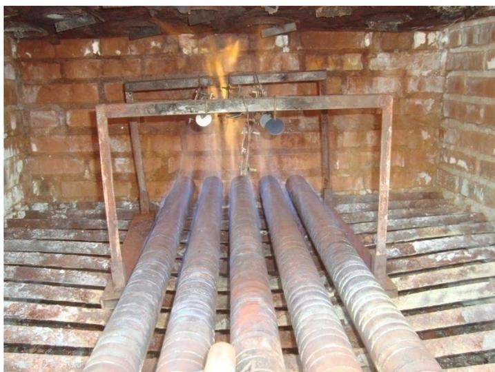
Figura 23: Fotografia dos corpos de prova expostos à chama da combustão do biogás.
