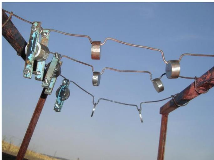
Figura 22: Fotografia da estrutura de sustentação dos corpos de prova na fornalha.
