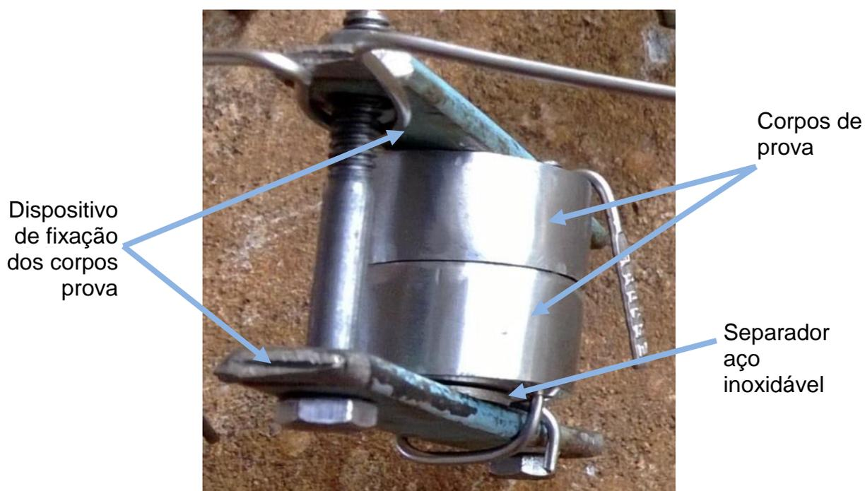
Figura 25: Fotografia do dispositivo para os ensaios de corrosão por fresta.
