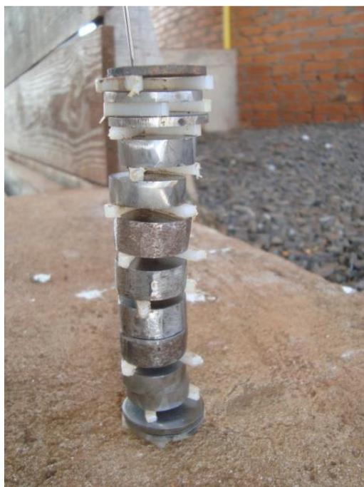
Figura 21: Fotografia dos corpos de prova montados antes de serem inseridos na câmara de corrosão de PTFE.
