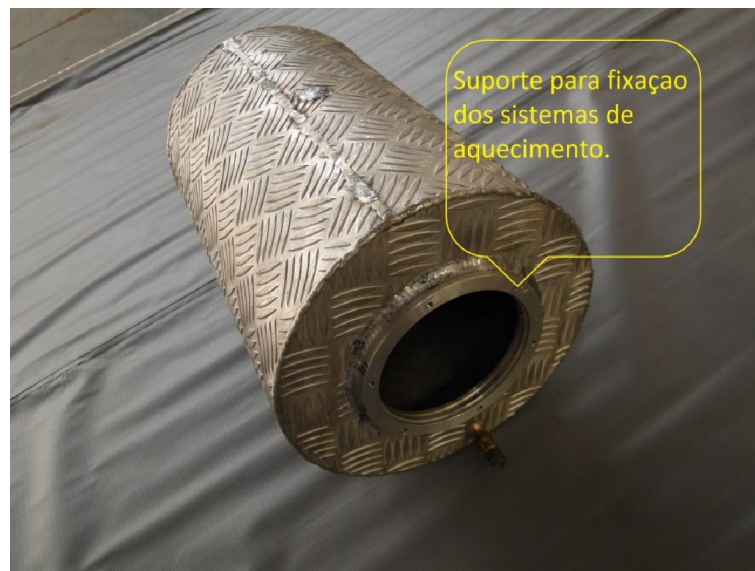
Figura 2 - Reservatório em alumínio.
