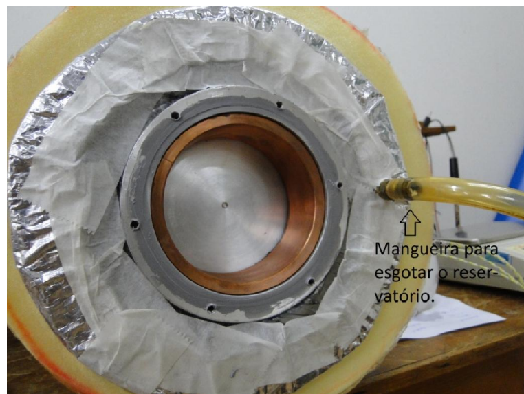
Figura 4 - Reservatório, detalhe do isolamento térmico
