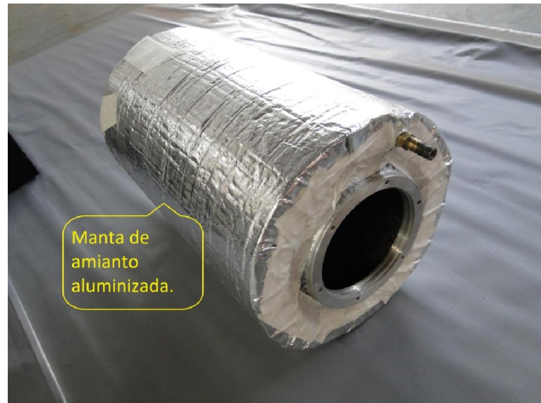
Figura 3 - Reservatório, detalhe do isolamento térmico.
