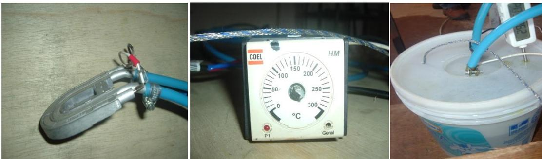
Figura 11 – Sistema de aquecimento dos combustíveis (Fonte: do autor).
