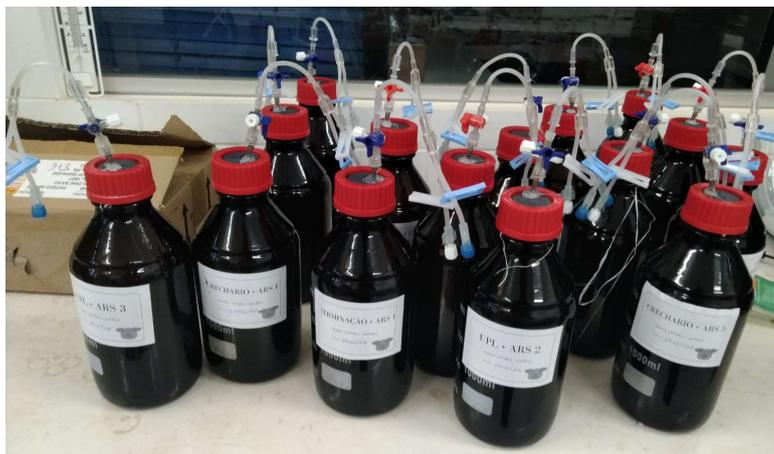
Figura 5 Frascos Duran utilizados no ensaio PBM
