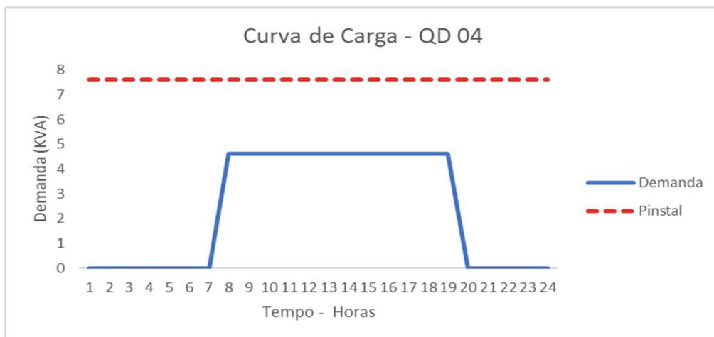
**Figura A22:** Estimativa de Curva de Carga – Quadro Distribuição QD 04
