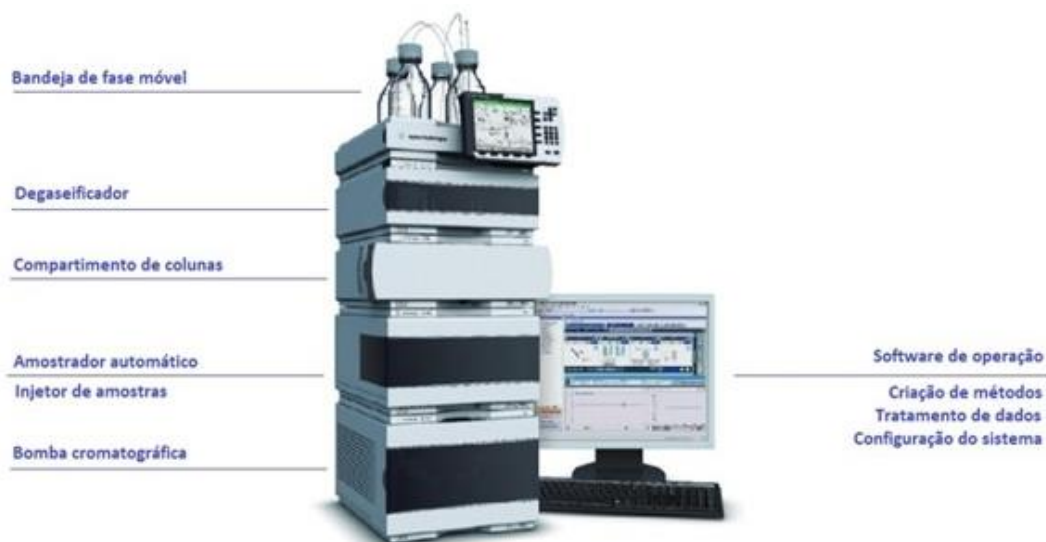
Figura 1: Diagrama ilustrativo dos principais módulos de um cromatógrafo líquido moderno.
