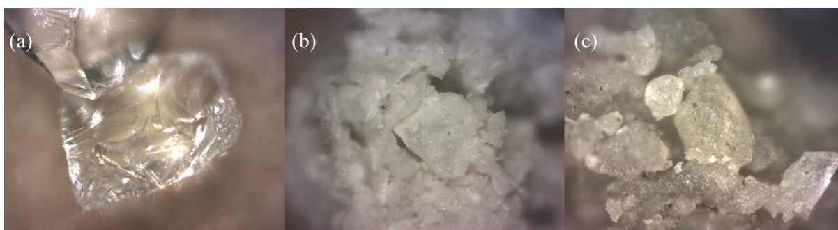
Figura 5.16. Fotografias obtidas pelo LIBS das amostras: (a) partículas de vidro residual; (b) catalisador KF/suporte e (c) catalisador KF/suporte após reação.
