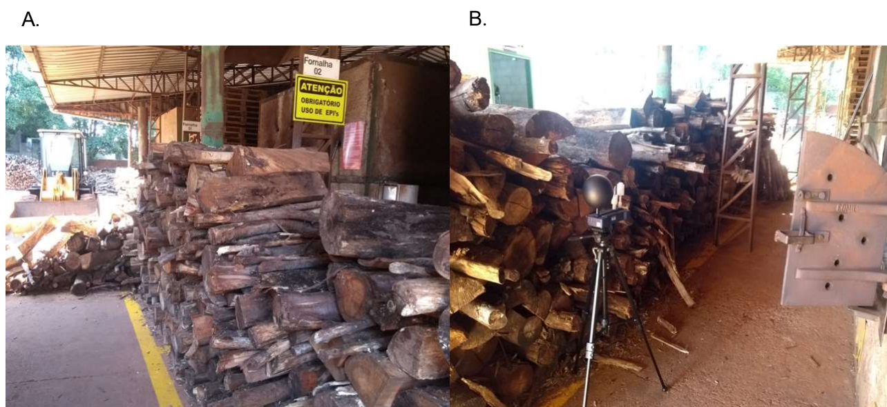
Figura 13 A) Estoque de lenha e local das fornalhas em período de safra e B) equipamento de calor posicionado e realizando coleta com escotilha da fornalha aberta. Fonte: O Autor
