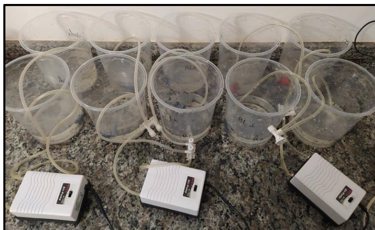
Figura 12. Aparato de bioensaio e compressor (aerador de aquário) utilizado na oxigenação dos recipientes. Fonte: A autora, 2021.
