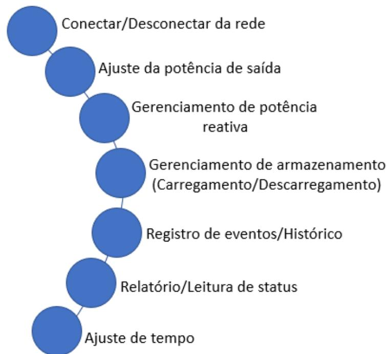
**Figura 1.2:** Sete principais funções dos *Smart Inverters*
