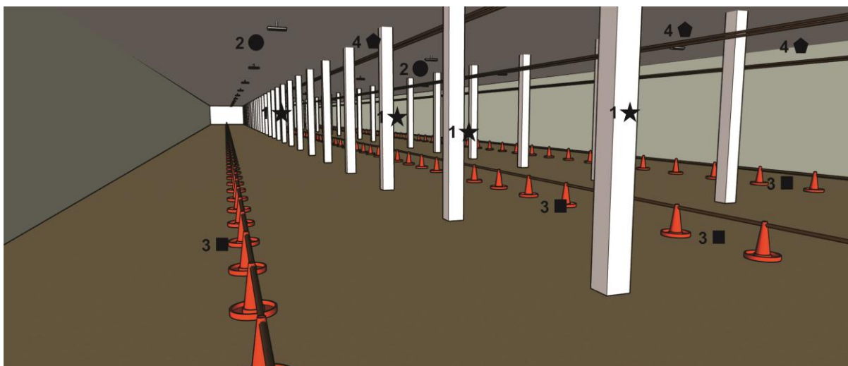
Figura 35: Perspectiva interna da proposta do aviário Dark House. 1-estrela: Pilares de sustentação, 2-bola: Lâmpadas instaladas, 3-quadrado: Comedouro das aves, 4-pentagono: Bebedouro das aves.
