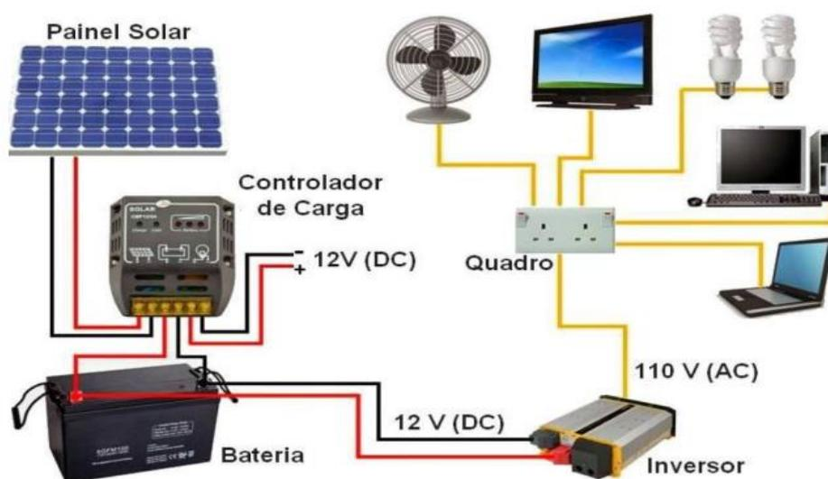
Figura 25 – Funcionamento de um sistema *off-grid*
