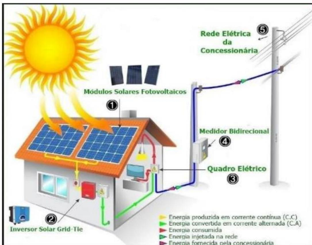
Figura 24 – Sistema fotovoltaico conectado à rede (on-grid)
