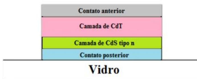
Figura 12 – Estrutura de corte de uma célula de CdTe
