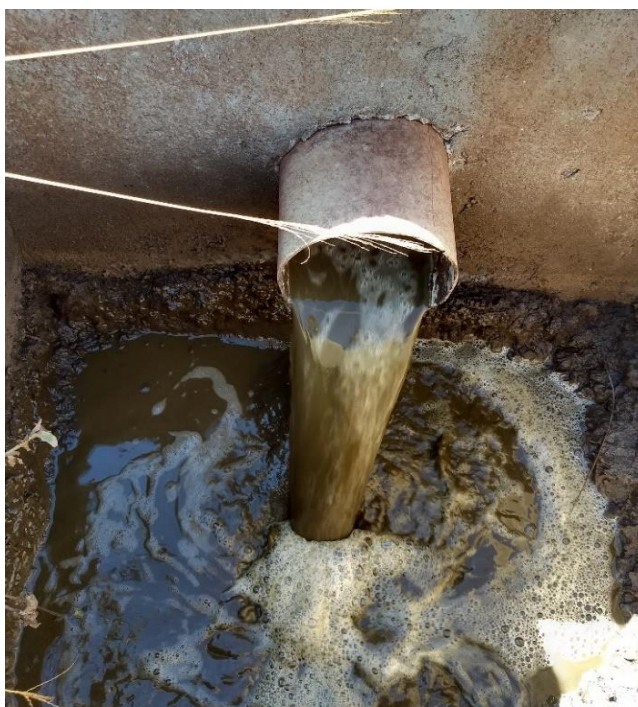
Figura 6 Biofertilizante utilizado como inóculo no ensaio semicontínuo.
