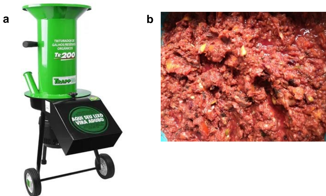
Figura 5 Triturador de resíduos orgânicos (a) e resíduos de frutas e verduras após pré-tratamento mecânico (b).
