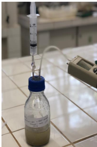
Figura 10 Leitura de gás e de pressão nos ensaios em batelada.
