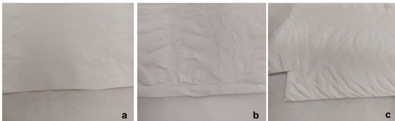
**Figura 15:** Membranas eletrofiadas AgNPs-CMC/PVA/Ecovio<sup>®</sup>. **a)** 25 mg de AgNPs-CMC em PVA; **b)** 30 mg de AgNPs-CMC em PVA; **c)** 35 mg de AgNPs-CMC em PVA.
