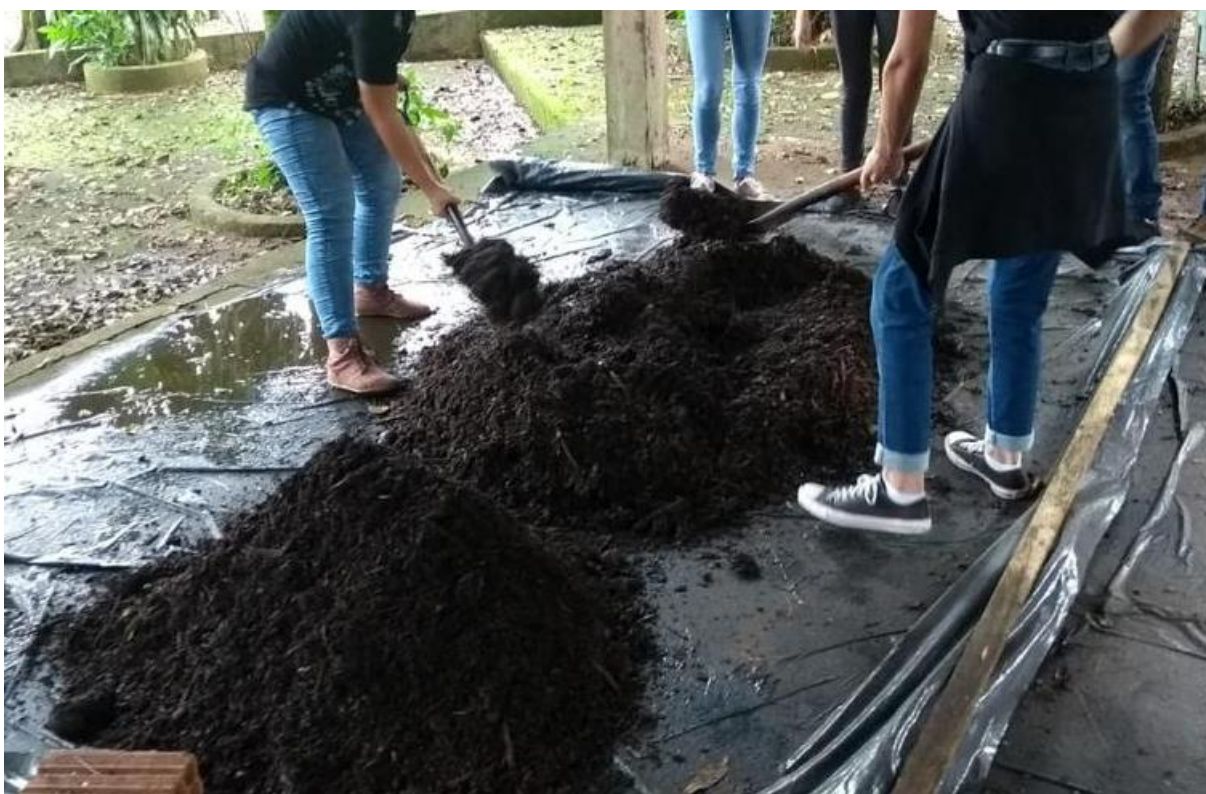
Figura 6 – Revolvimento manual das pilhas de compostagem com auxílio de pá.
