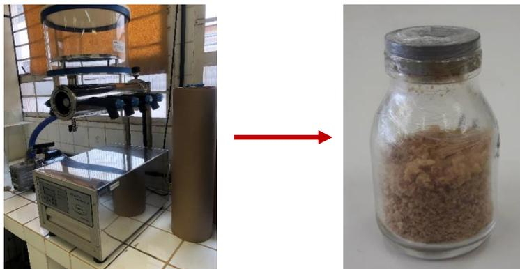
**Figura 6** Liofilizador de bancada Enterprise II Terroni e exsudado liofilizado.
