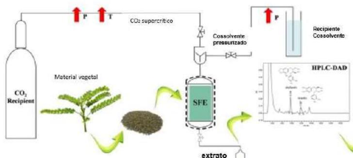
Figura 5 Representação esquemática do processo de extração com fluido supercrítico (PEREIRA *et al.*, 2017).
