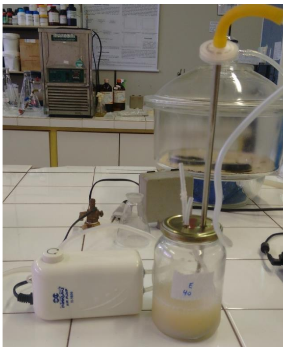
Figura 2 - Reator e sistema de aeração utilizado nos cultivos de S. boulardii com aeração.
