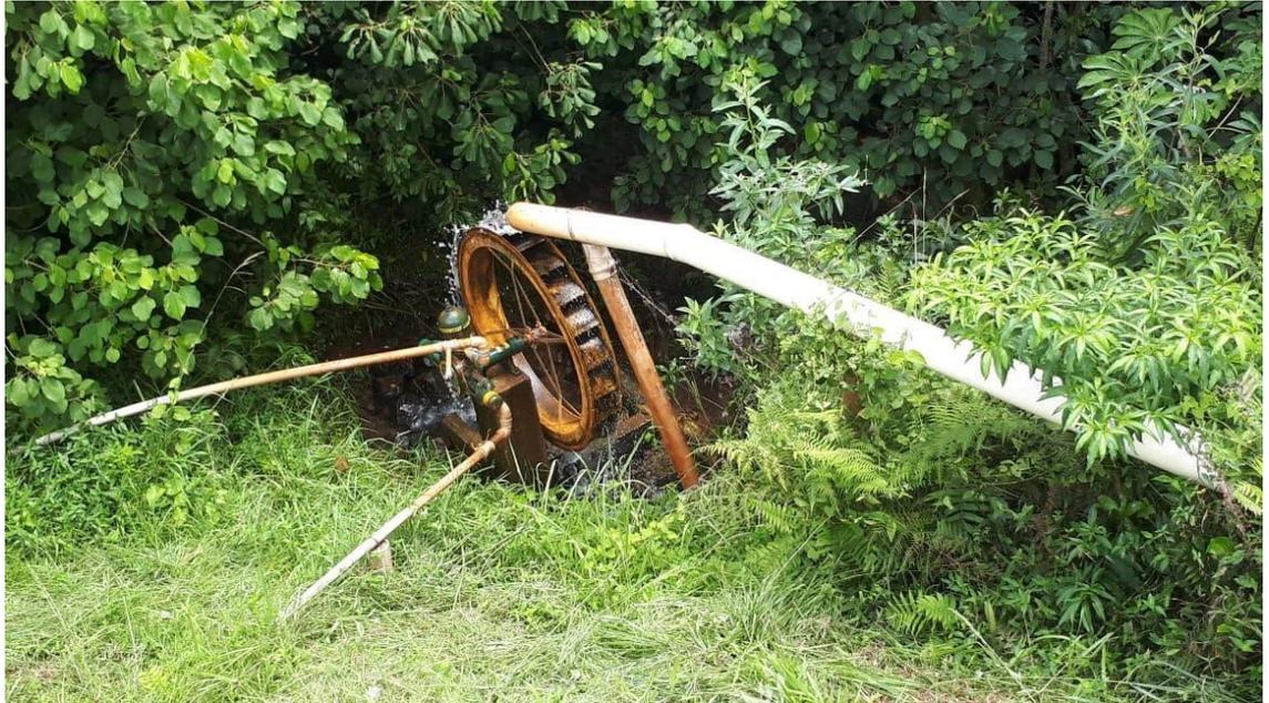
Figura 12 - Imagem da roda d'água movida com a água que sai do açude
