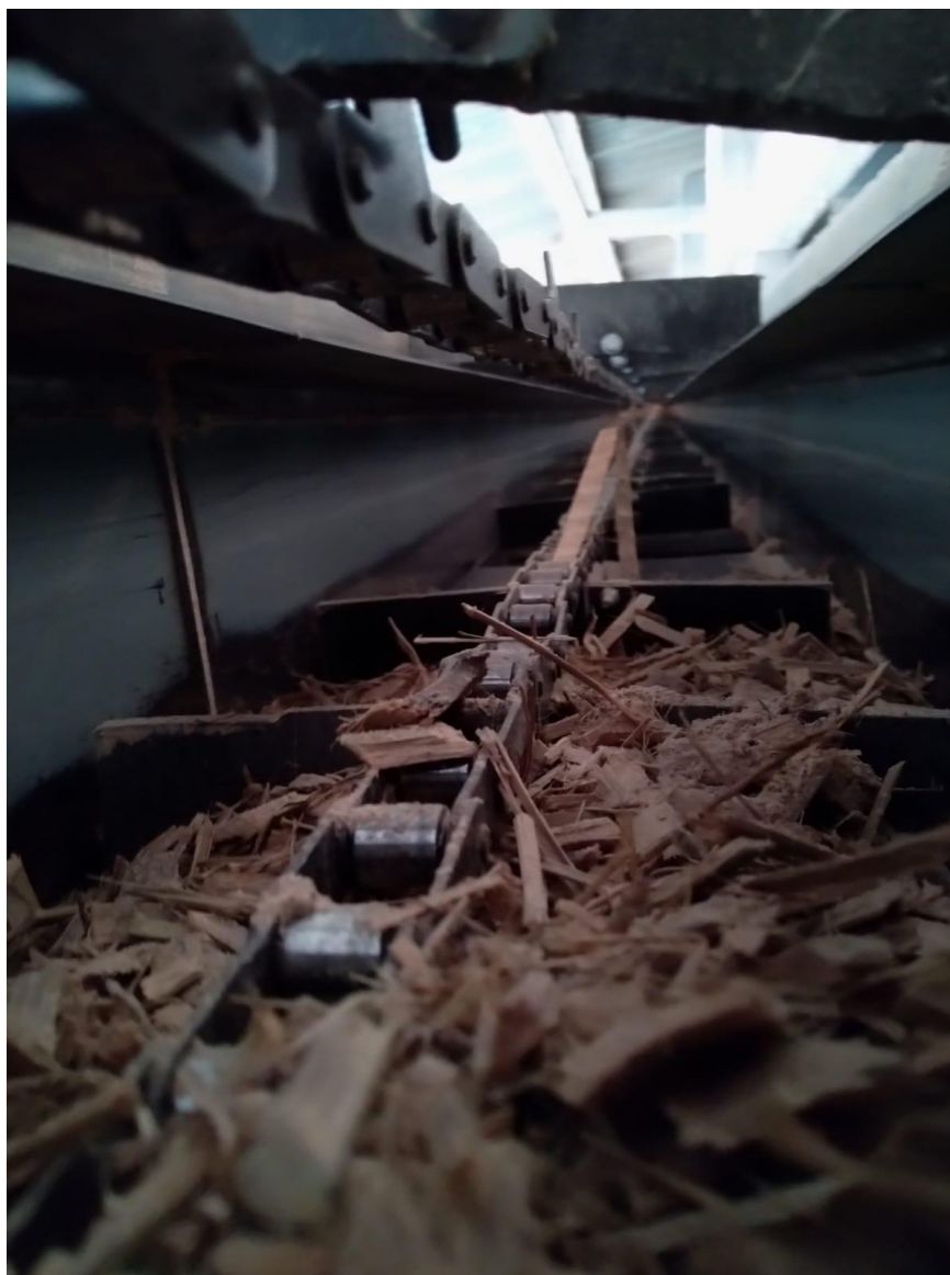
Figura 11 - Elevador de cavacos utilizados para o transporte do material até o forno de queima Fonte: Autor, (2021).
