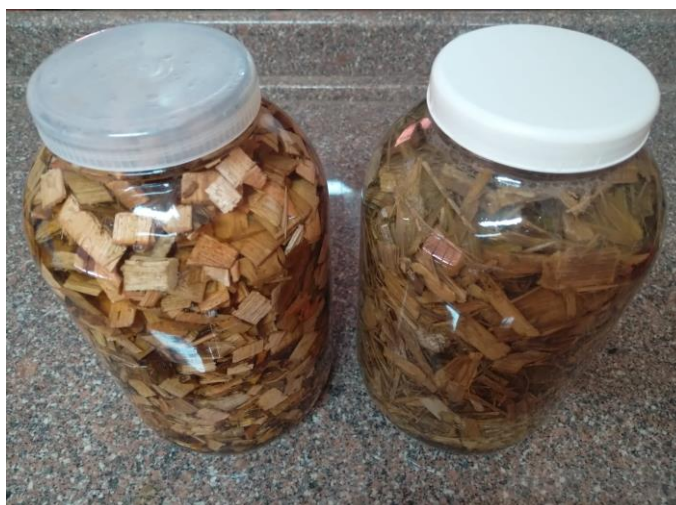
Figura 16 - Cavacos de eucalipto e de bambu submersos para o ensaio de densidade
