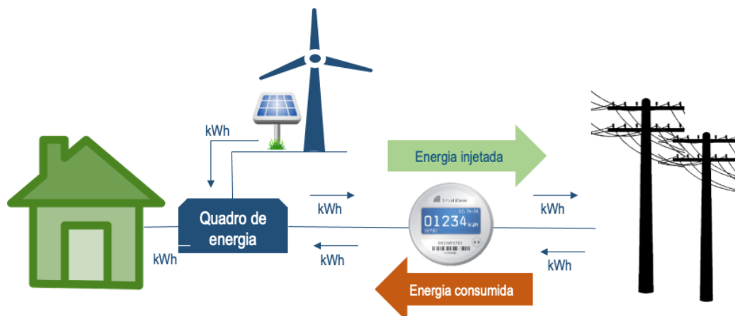
FIGURA 7 - MODELO DE COMPENSAÇÃO DE ENERGIA ELÉTRICA
