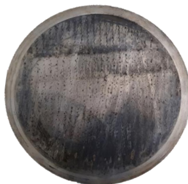
Figura 4.1: Placa bipolar do eletrolisador alcalino da PPH do PTI.
