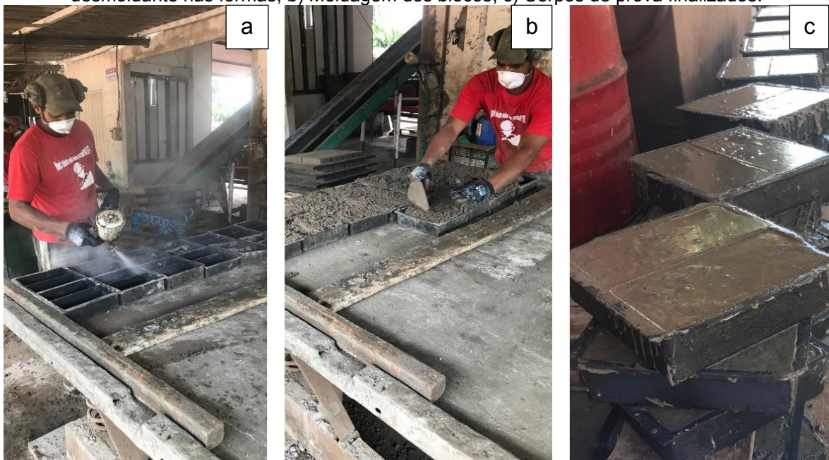
Figura 9 – Representação gráfica com o processo de fabricação dos pavimentos: a) Aplicação de desmoldante nas formas; b) Moldagem dos blocos; c) Corpos de prova finalizados.
