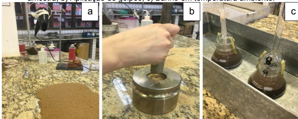
Figura 8 – Sequência de procedimento para obtenção da densidade e massa úmida: a) Secagem da amostra; b) Aplicação de golpes; c) Banho em temperatura ambiente.
