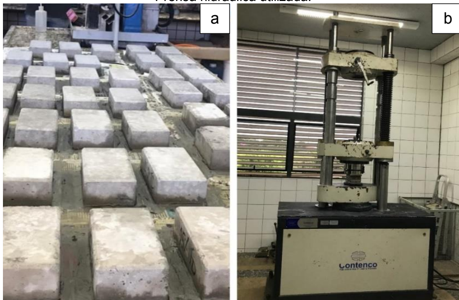
Figura 10 – Representação gráfica do ensaio de Resistência à compressão: a) Blocos capeados; b) Prensa hidráulica utilizada.
