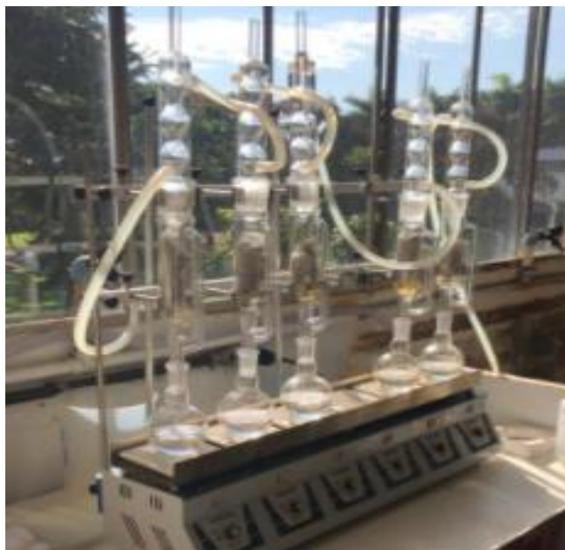
Figura 12. Extração do óleo de pinhão-manso cultivado sob aplicação de ARS. Fonte: O autor, (2021).
