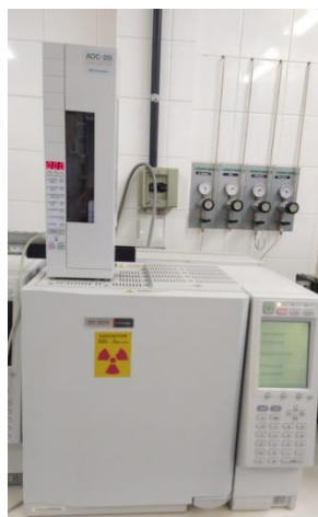
Figura 8 GC-ECD, Shimadzu CG-2010, localizado no laboratório de análises agroambientais da Universidade Estadual do Oeste do Paraná.
