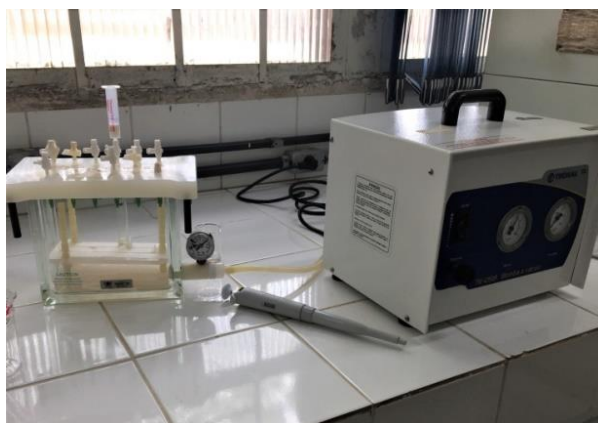
Figura 4 Coletas de extratos em tubos de ensaios sob vácuo.
