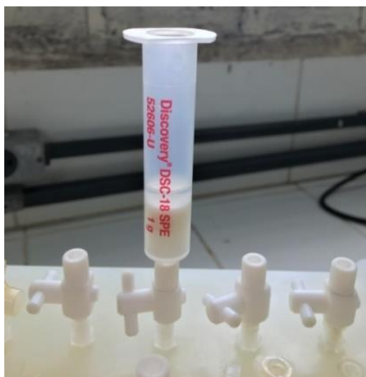
Figura 3 Condicionamento dos cartuchos SPE C18 1000 mg / 6 ml conectado a um Minifold.
