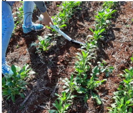
Figura 7 Coleta de dados de IAF com o LAI-2200C na fase de roseta.
