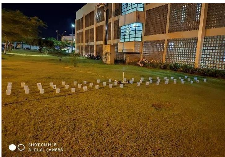
**Figura 4**- Croqui Grid amostral 1 de coletores e o aspersor móvel em campo
