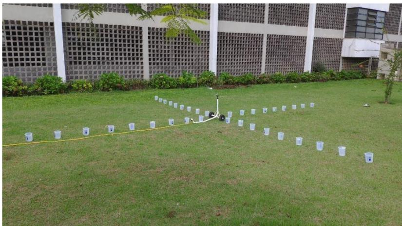
**Figura 6 - Croqui Grid 2 de coletores e carro aspersor em campo**
