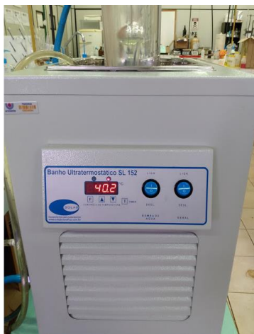
Figura 13. Ensaio da viscosidade cinemática
