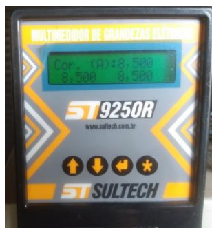
Figura 14. Multimetro de grandezas elétricas
