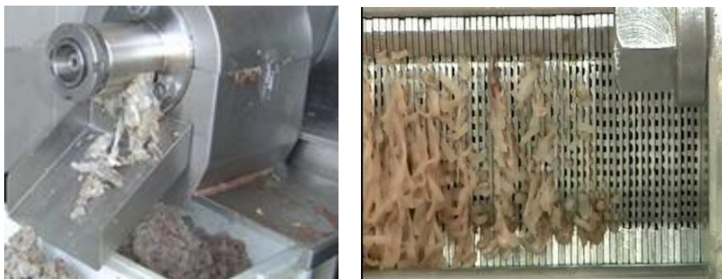
Figura 8. Extração da Carne Mecanicamente Separada (CMS) de peixe utilizando desossadora tipo rosca sem fim
